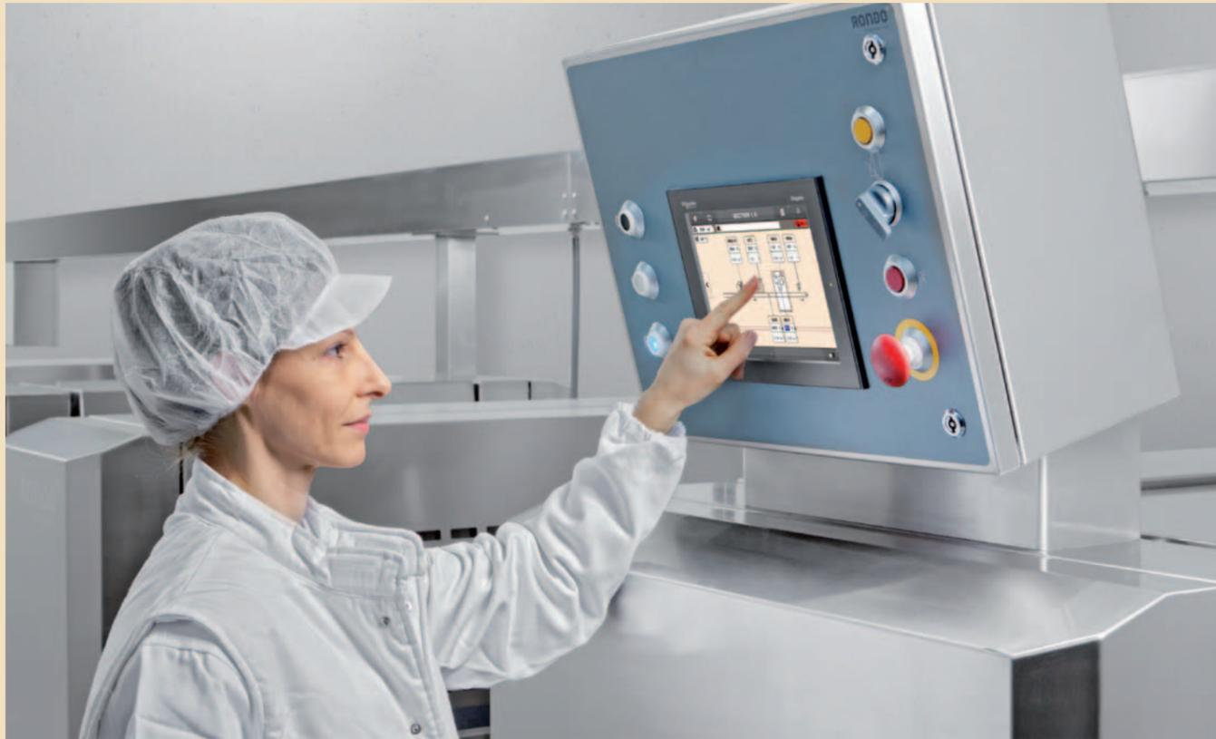
In modernen industriellen Backbetrieben sind häufig komplexe und vernetzte Produktionslinien im Einsatz. Flexible, zuverlässige und leicht zu bedienende Steuerungssysteme tragen daher entscheidend zur Prozesssicherheit sowie zur Effizienzmaximierung bei. Bei Linien von RONDO werden bei Änderungen der Einstellungen alle nachfolgenden Motoren mittels Kaskadensteuerung reguliert und synchronisiert.
