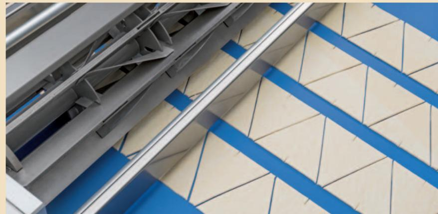
Die Dreiecke können mit einer Schneidewelle oder einer Guillotine aus dem Teigband geschnitten resp. gestanzt werden.
