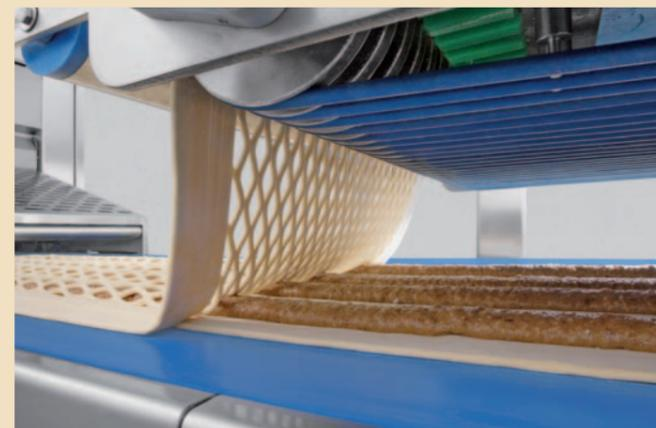
Beim Überführen bedecken Sie die Füllung mit einem zweiten Teigband und stanzen anschließend die Produkte aus.
