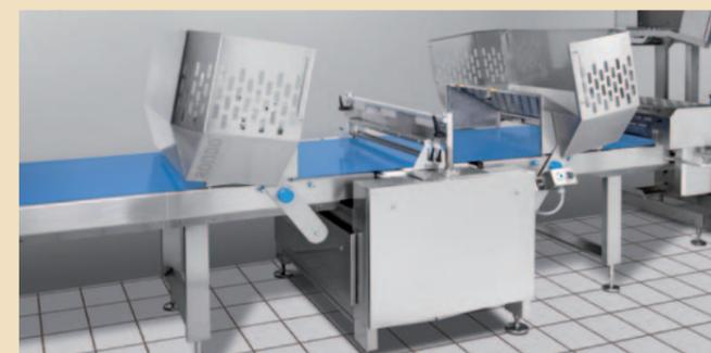
Die gute Zugänglichkeit der Guillotine im ASTec-Design erleichtert die Reinigung.
