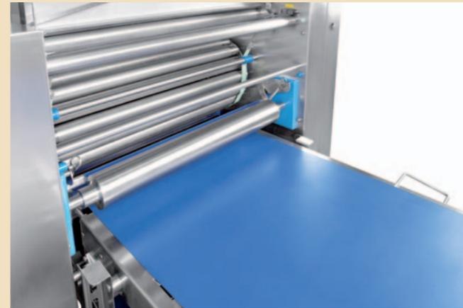
Die weit öffnenden Schutzgitter und die Freiräume zwischen den einzelnen Linienkomponenten stellen eine gute Zugänglichkeit aller Reinigungspunkte sicher.
