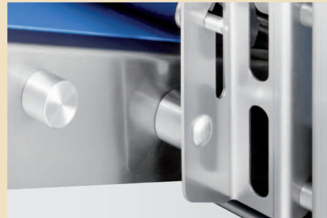
Alle Teile der ASTec-Linie sind so gebaut, dass sich kein Schmutz ansammeln kann.
