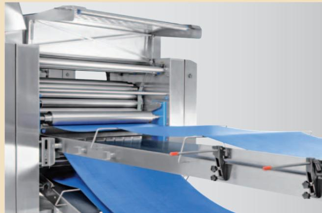
Es kommen ausschliesslich Materialien zum Einsatz, die leicht gereinigt werden können. Das Transportband verfügt zusätzlich über versiegelte Kanten.
