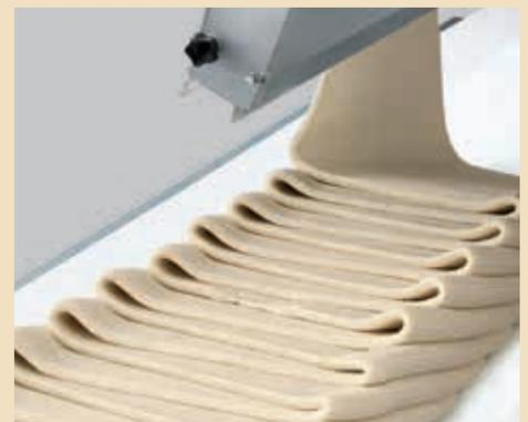
Avec la ligne de laminage RONDO MLC, vous automatisez la production de produits à base de pâte feuilletée ou en feuilletée briochée et ravitaillez la Starline en continu.
