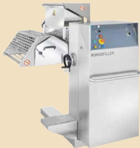
Le Rondofiller dépose tous types de garnitures en douceur et en respectant avec précision le poids fixé. Il peut être équipé de vis sans fin, de pistons ou de pompes Mohno et il est, de ce fait, extrêmement flexible. En version Profinet, il peut également être intégré à la télémaintenance de la Starline.
